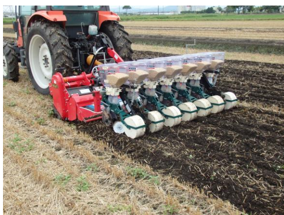
写真5 一発耕起播種機による播種（麦跡）
