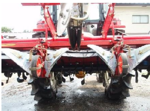
写真3 ドライブハローに培土板を装着した事例
