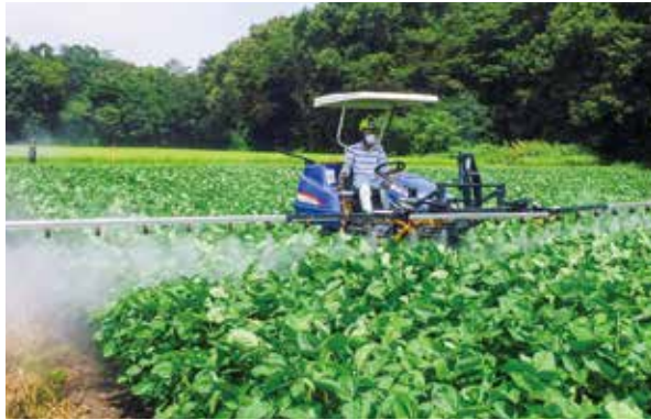
【写真4 乗用管理機による大豆病虫害防除】
